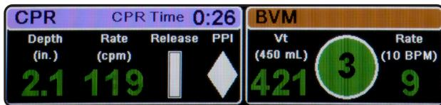
Bei lebensbedrohlichen Einsätzen mit Herzstillstand verfügt der neue X Series Advanced Monitor/Defibrillator sowohl über Real CPR Help<sup>®</sup> als auch Real BVM Help, so dass die Rettungskräfte gleichzeitig Echtzeit-Feedback zur Qualität der Kompressionen und der Beatmung erhalten. Beim Einsatz mit CPR-Elektroden für Erwachsene von ZOLL zeigt die X Series Advanced das Real BVM Help Dashboard neben dem Real CPR Help Dashboard an.
