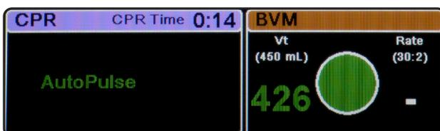
Wird der AutoPulse genutzt, erkennt die X Series Advanced automatisch die Kompressionen des AutoPulse und zeigt diese auf dem CPR Dashboard an.
